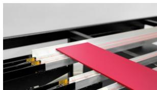
Упор задний позволяет выставлять калиброванный отступ от края детали до ближайшего гиба, что очень удобно при серийной гибке одинаковых изделий.
