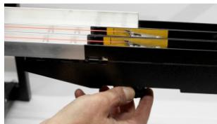
Регулировка зазора между струной и заготовкой плавная от 0 до 9 мм. ручками под левым и правым краем блока струны.
